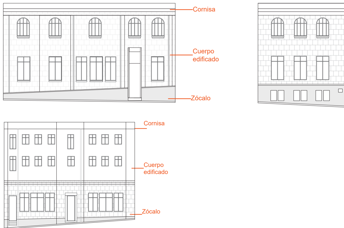
Figura 32. Elevación fachada contigua al proyecto
