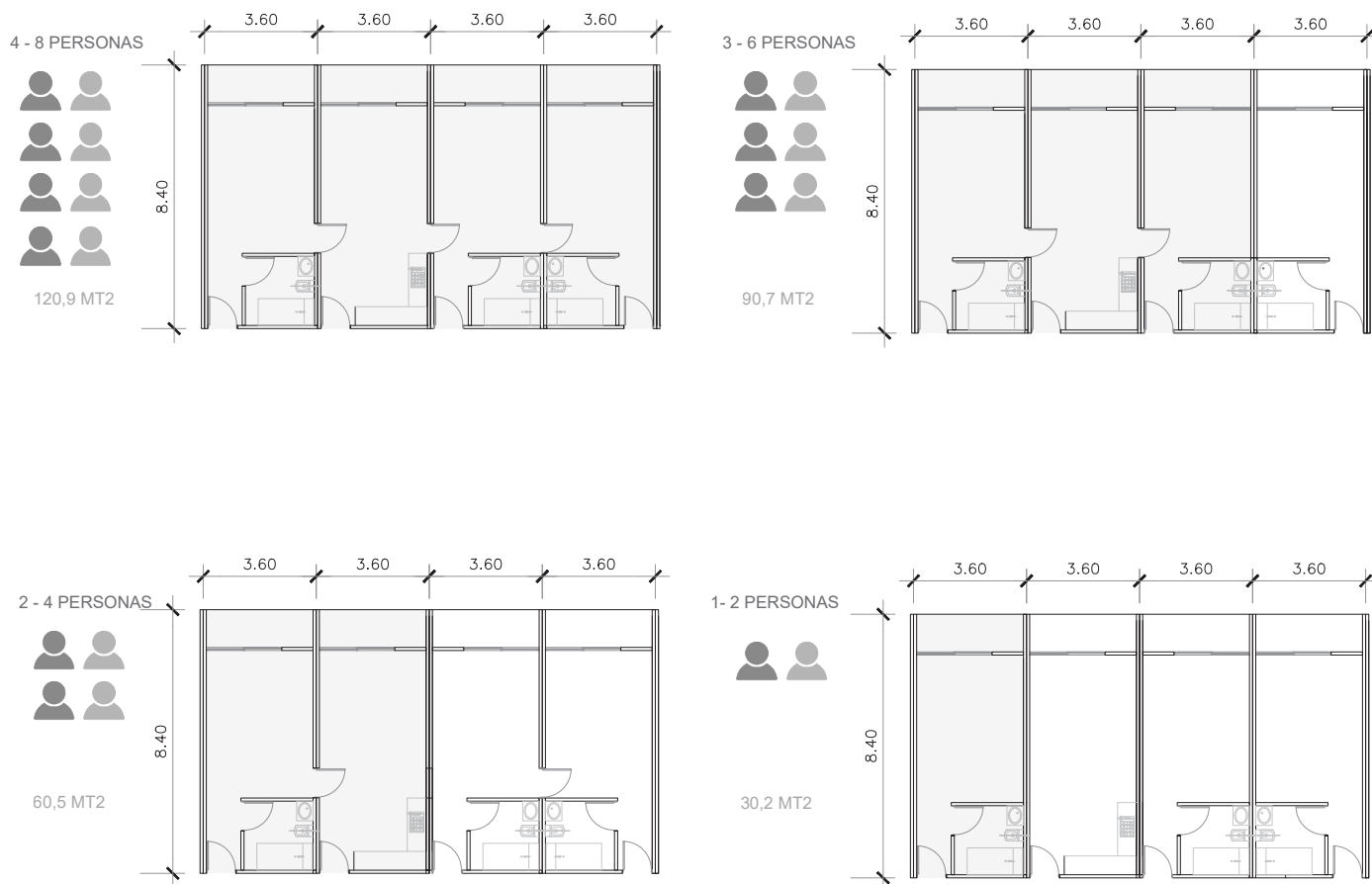
Figura 39. Diagrama Flexibilidad de Módulo en la horizontal.
