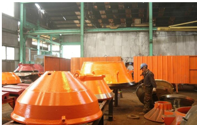
Revestimientos de acero fundido para chancadoras, listos para despacho.
