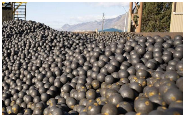
Bolas de molienda de acero forjado nuevas en acopio.
