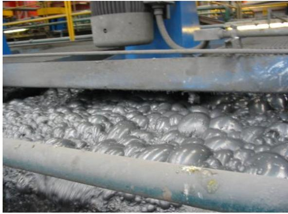
Fuente: Fotografía celdas de flotación, planta El Soldado
