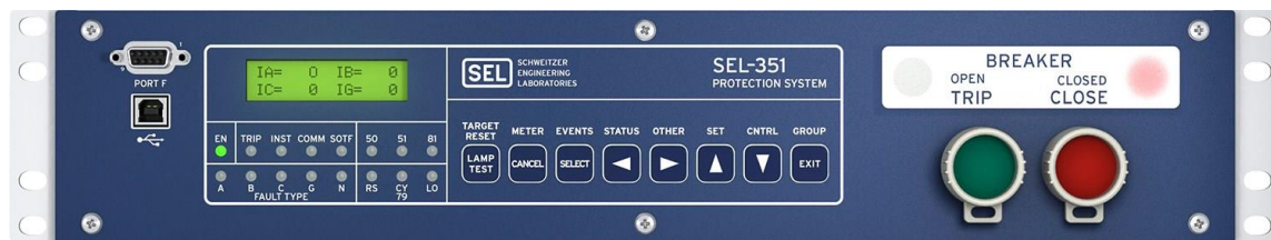
Figura 2.8: Relé de protección SEL-351.
