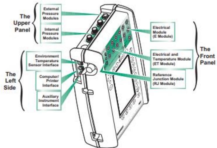
Figura 3.2 Beamex MC-5 secciones.
