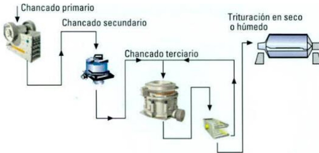
Figura 2.5: Ejemplo de circuito con chancado de 3 etapas clásico previo a ingreso al molino de barras (Minero, 2006).
