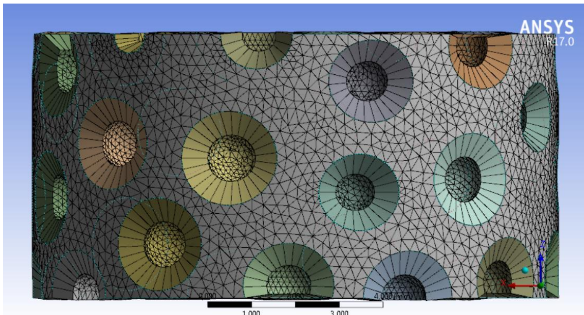
Figura 29: Ejemplo de modelo mallado con parámetros seleccionados.
