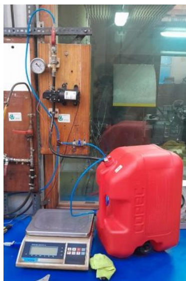
Figura 52. Sistema de inyección de agua.
