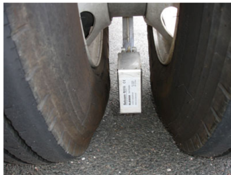
Figura 2.18: Primer plano del sensor láser colocado entre neumáticos duales
