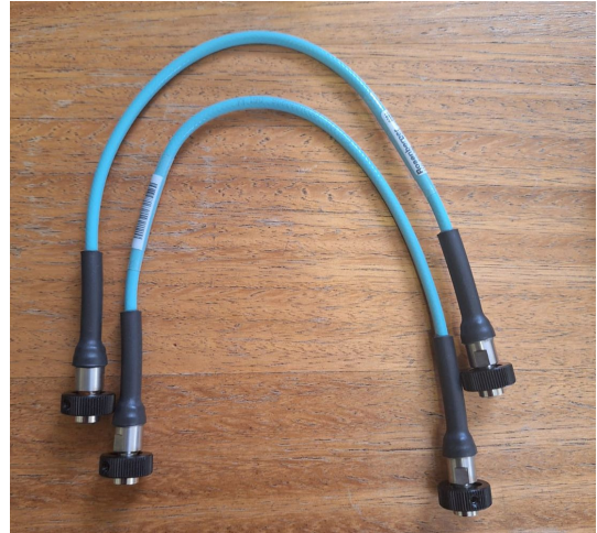
(b) Cables coaxiales de baja pérdida.
