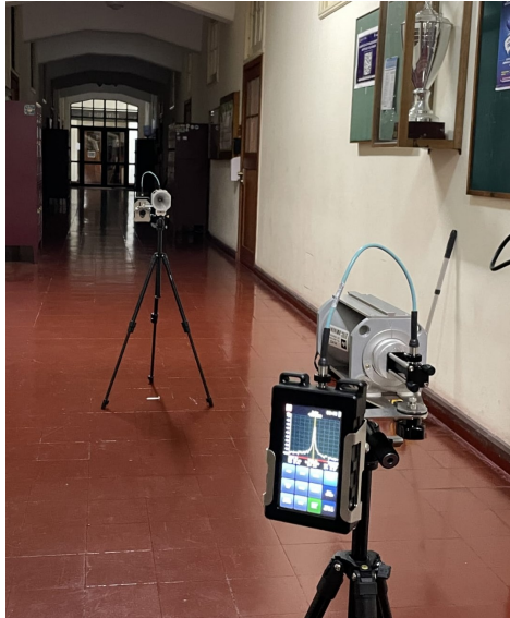
Figura 3.12. Vista del enlace de medición en el pasillo (tramo LoS). Se aprecia el SAF Spectrum Compact conectado a la antena de bocina, montado sobre el trípode del receptor.
