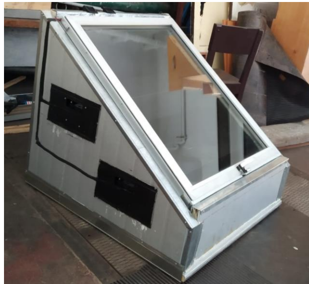
Ilustración 46: Prototipo construido, extremo extractores
