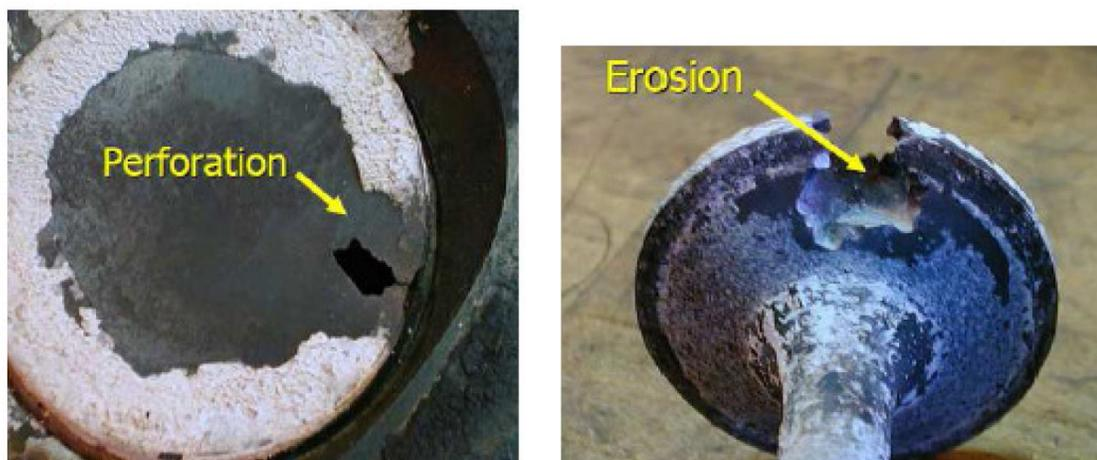
Figura 7-2: Efectos del  $H_2S$  en instalaciones.
