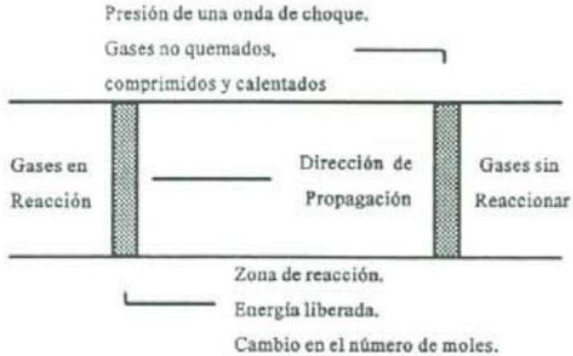
Figura 4-2: Reacción y presión de propagación frontal a través de un tubo.
