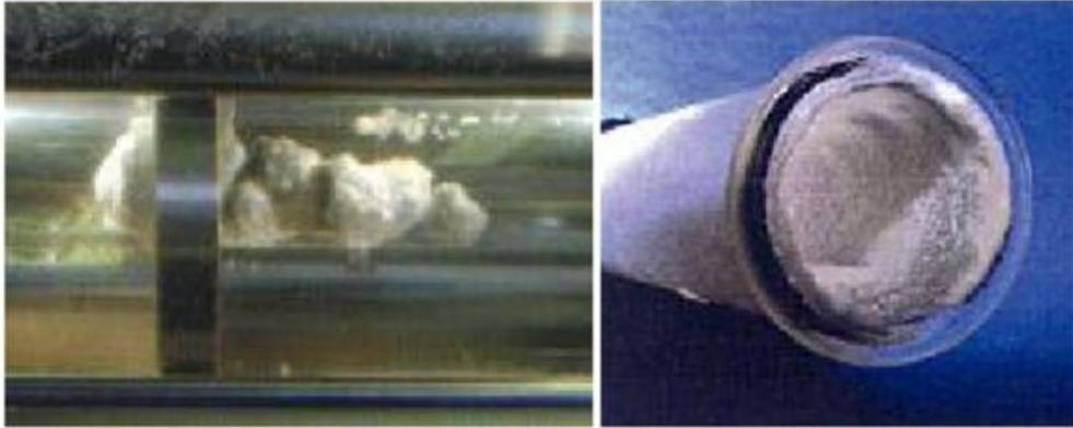
Figura 7-3: Hidratos de metano en tubería [31].
