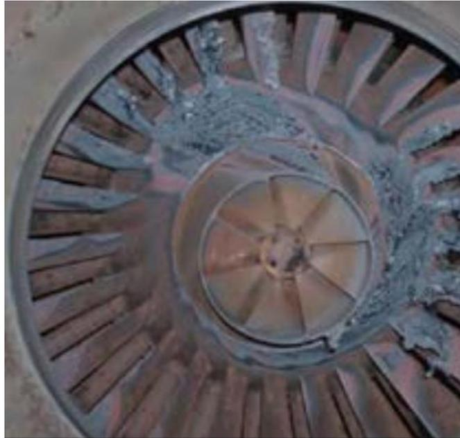
Figura 4-7: Falla de turbina a gas debido a fenómeno de retroceso de llama [22]
