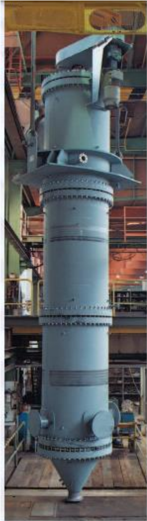
Anexo 1: Destilador molecular marca VTA de 2 ton/h
