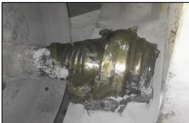
Figura 4.14 - Rodamiento contaminado posterior a medición de juego radial interno.
