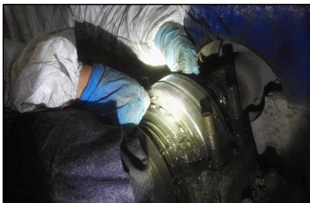
Figura 4.13 - Medición de juego radial interno en rodamientos de bloques de almohada.
