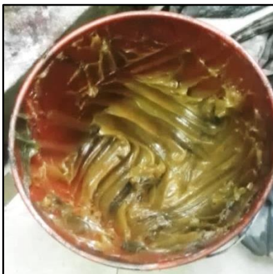
Figura 4.4 - Grasa lubricante contaminada.
