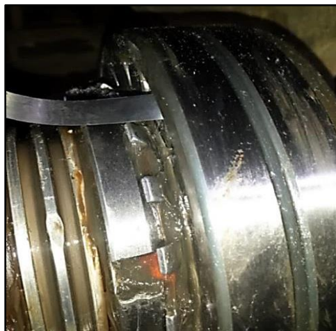
Figura 4.6 - Medición de holgura en rodamiento.
