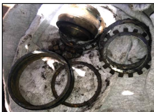
Figura 4.3 - Rodamiento de soporte de pie desarmado posterior a falla.
