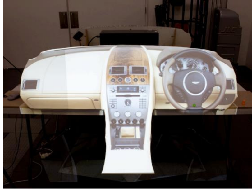
Figura 2. Prototipo de tablero de auto realizado con SAR. (Porter et al., 2010)
