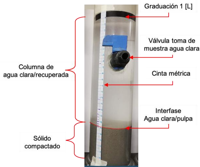
Figura 5.5. Probetas para sedimentación [E.P].
