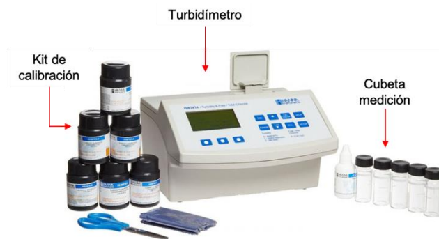
Figura 5.9. Turbidímetro HI-83414, con cubetas de medición y set de calibración.
