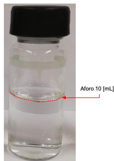
Figura 5.6. Cubeta medición de turbidez [E.P].
