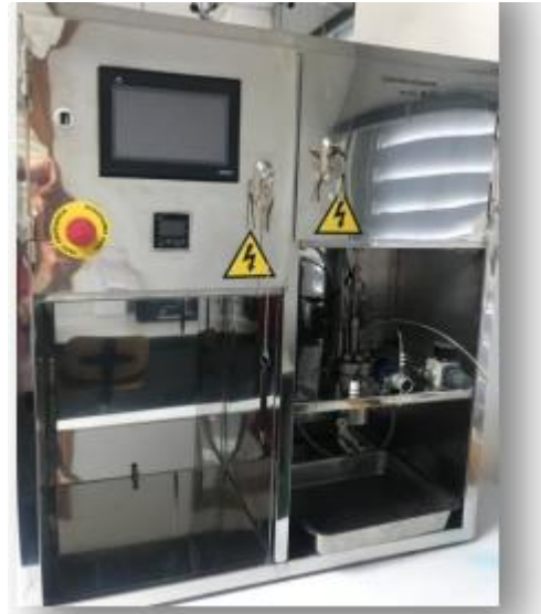
Figuras 2-1 Fotografía del Termorresistómetro Matia, en el laboratorio de calidad y seguridad alimentaria de la Escuela Técnica de Ingenieros Agrónomos en la Universidad Politécnica de Cartagena.
