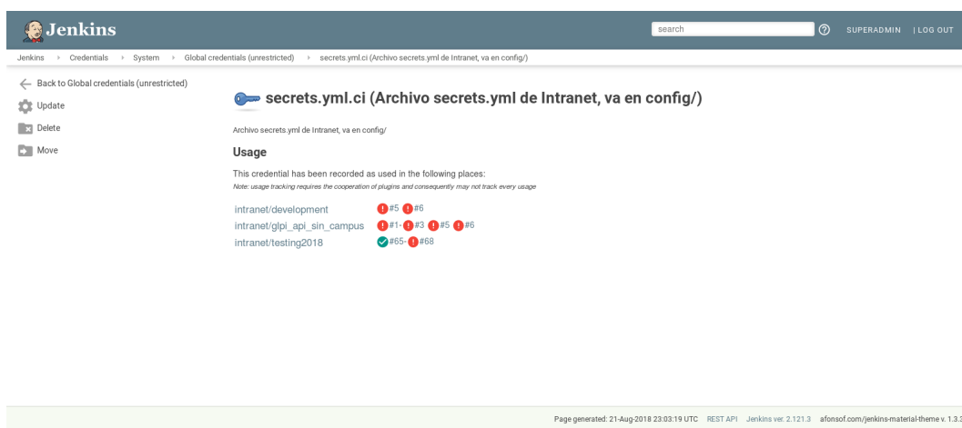
Figura 5.7 – Captura de pantalla de Jenkins, donde se muestra el uso del plugin de credenciales. Fuente: Elaboración propia
