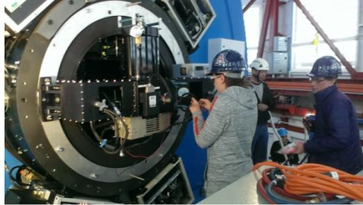
Figura 4.1: Fotografía de proceso de montaje de cámara infrarroja Clio2 en puerto Nasmyth (NAS) del Telescopio Clay. Fuente: “2014b Day 5: Corrected Dispersion”, en <http://visao.as.arizona.edu>, 31 Oct. 2014.
