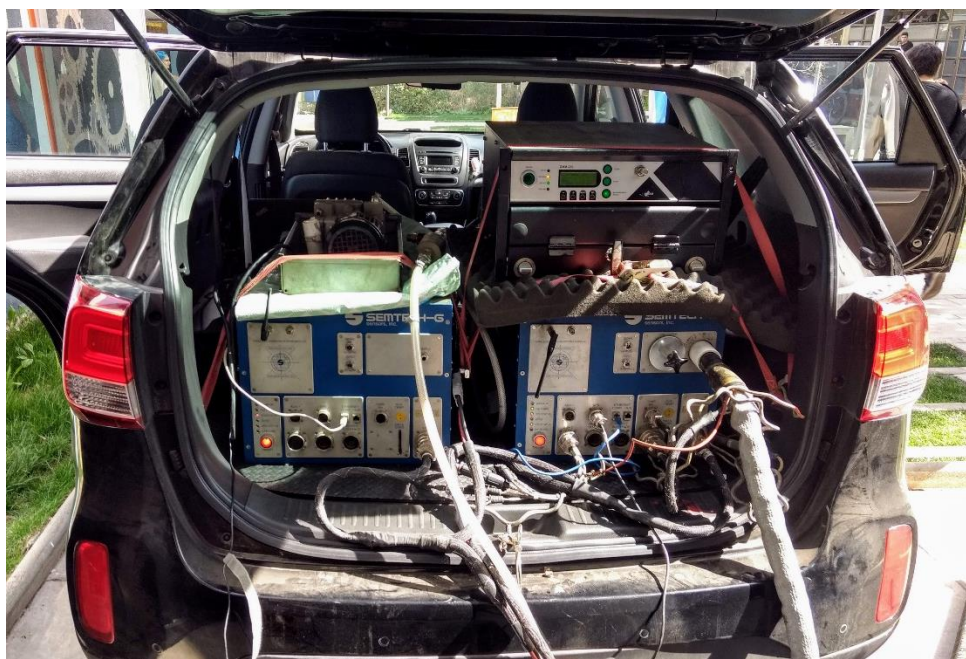
Figura 3.3: Montaje de los equipos de medición al interior del vehículo junto a las líneas de muestreo, alimentación y conexión. Las baterías (no visibles en la figura) se posicionan en la parte posterior de los equipos.
