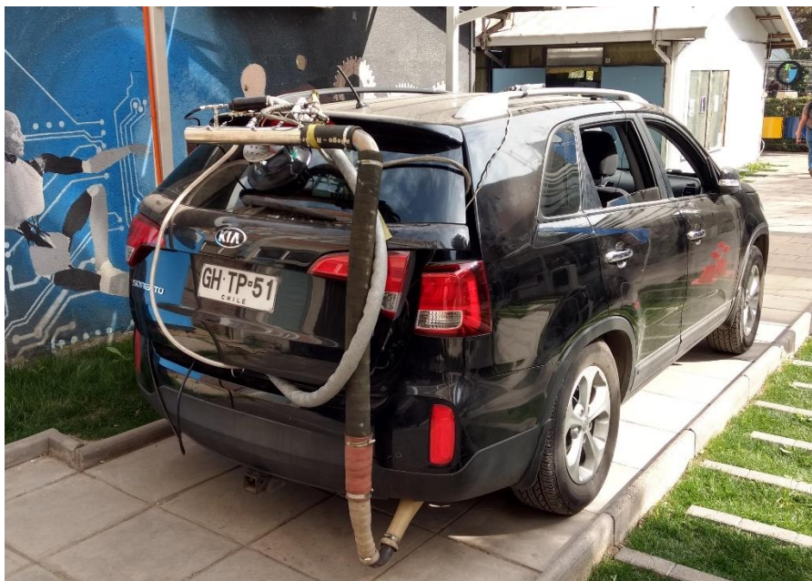
Figura 3.4: Montaje finalizado, se aprecia la sonda de muestreo en el parabrisas trasero, de donde se alimentan todos los sensores de emisiones con sus respectivas líneas.
