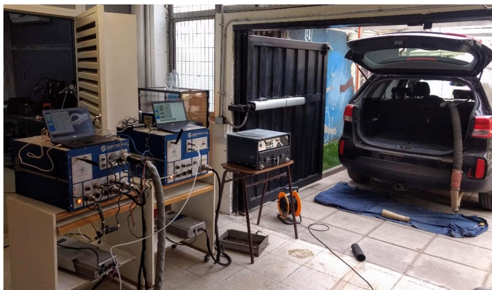
Figura 3.2: Preparación de los sistemas de medición previo al montaje al interior del vehículo, revisión de los analizadores, filtros y calibración.
