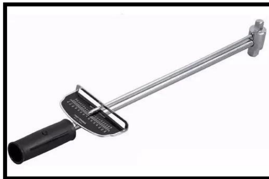
Figura 1-1 llave torque tipo aguja
