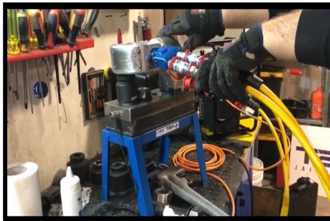
Figura 2-10 aplicación torque hidráulico
