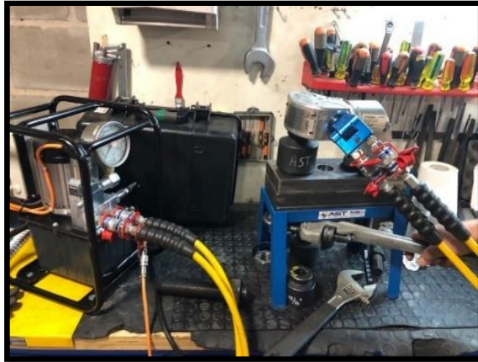
Figura 2-9 aplicación torque hidráulico
