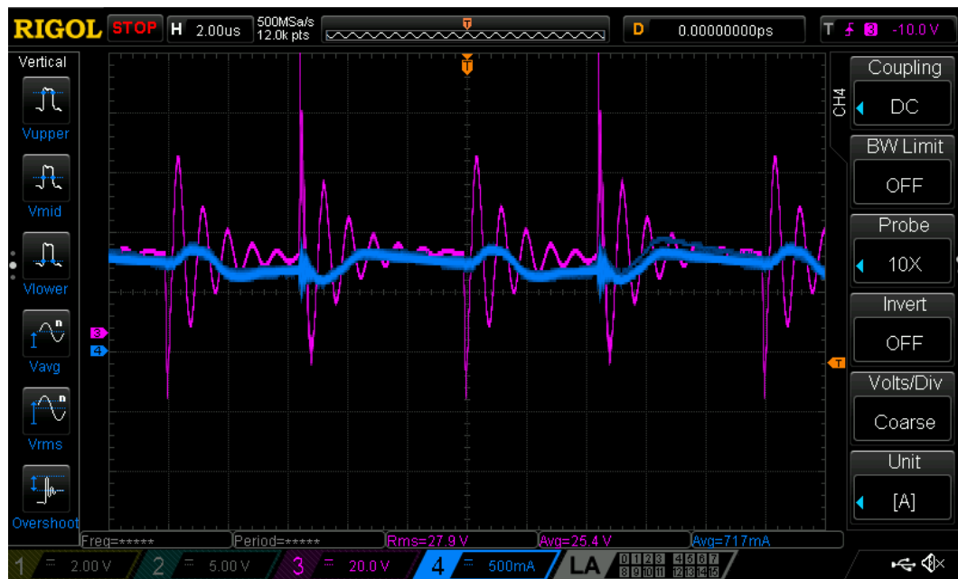
Figura 4.11: Voltajes y corriente en resistencia de salida.
