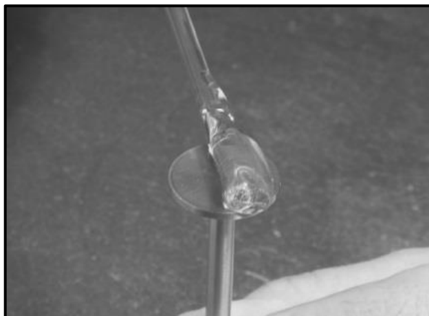
Fig. 5. Uso de una varilla de vidrio para colocar el líquido de referencia en el plato.
