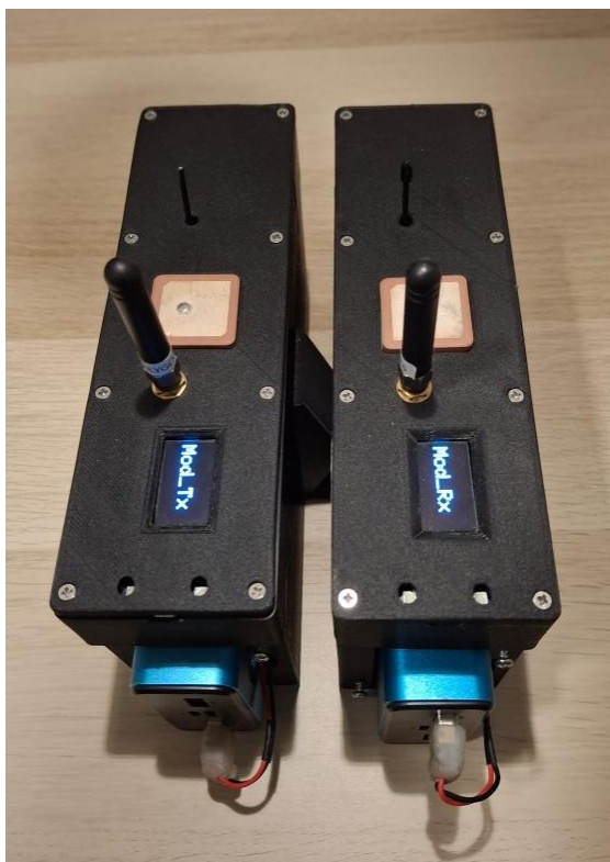
ANEXO B: Fotografía de equipo Tx y Rx conectados a power bank.
