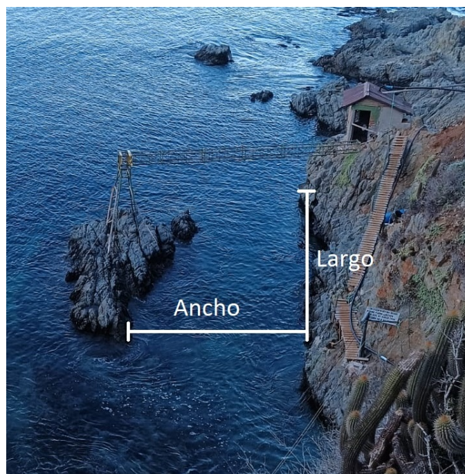
Figura 22: Canal de olas Laguna Verde. Largo: 15[m], Ancho: 4.5[m](sector más estrecho). .
