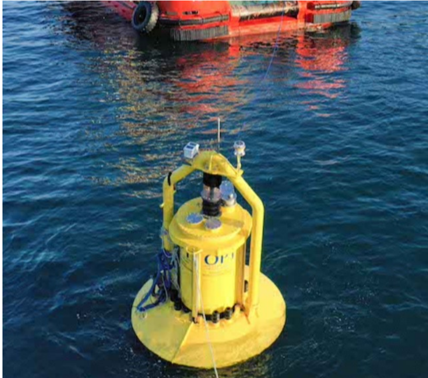
Figura 20: Equipo PB3 PowerBuoy, frente a la costa de Valparaíso, a dos kilómetros de Las cruces [26].
