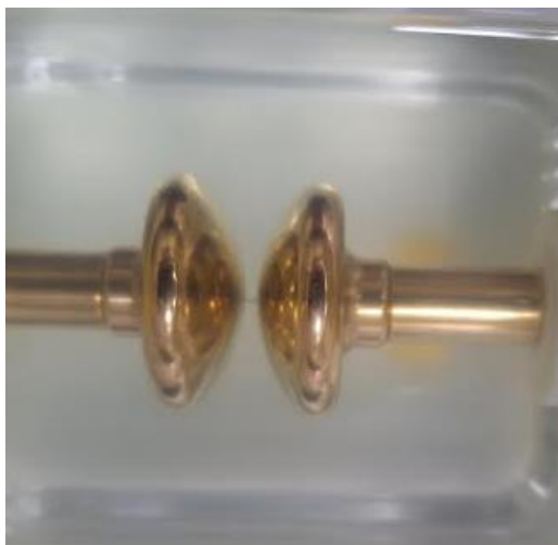
Figura 30: Puente post ensayo de rigidez dieléctrica.
