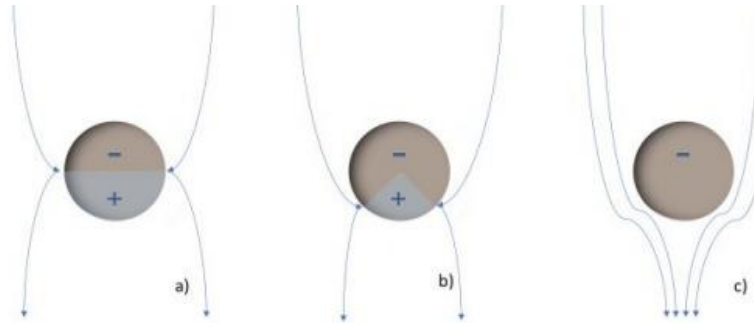
Figura 9: Cambio de polarización de nanopartícula sometida a campo eléctrico.
