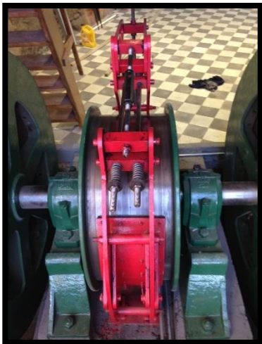
Figura 2.14: Sistema de Freno de Servicio Fuente: Elaboración Propia
