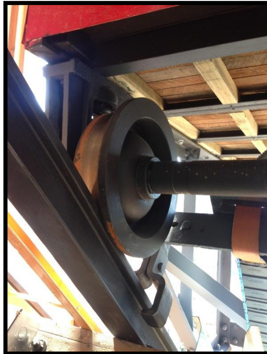
Figura 2.10: Rueda de acero de fundición Fuente: Elaboración Propia
