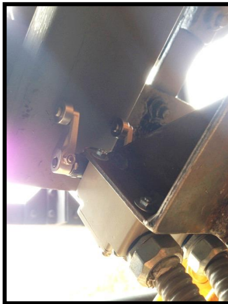
Figura 2.12: Sensor de Contacto de Desaceleración activado Fuente: Elaboración Propia
