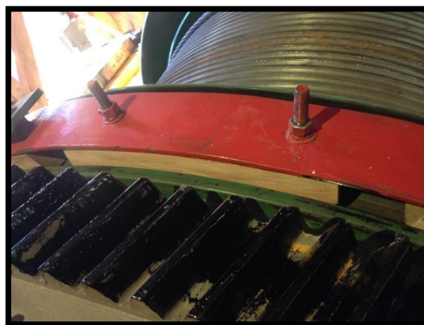
Figura 2.20: Balata de madera central Fuente: Elaboración Propia
