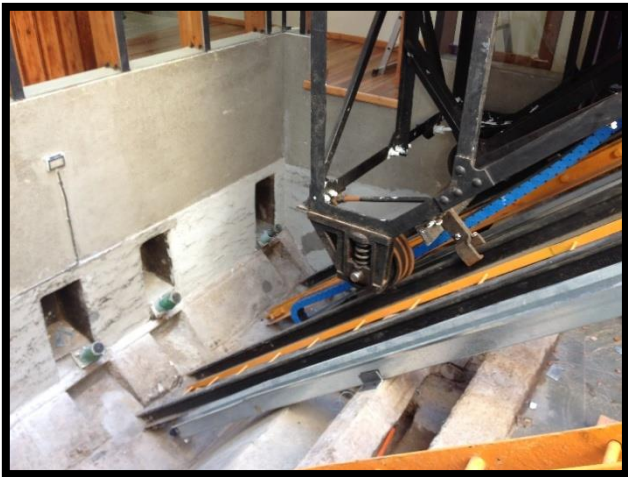
Figura 2.4: Cuatro amortiguadores montados en estación inferior de funicular El Peral Fuente: Elaboración Propia
