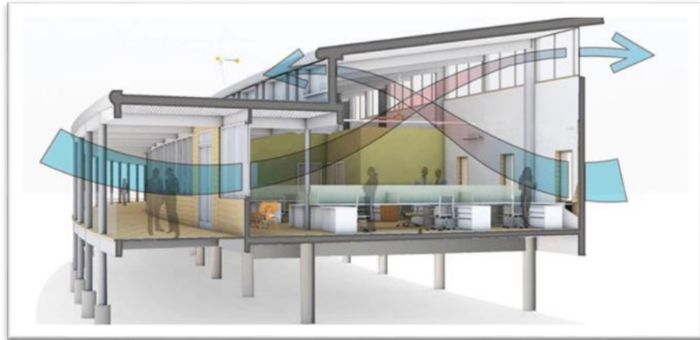
Ilustración 11: Diseño computacional de ventilación cruzada en vivienda
