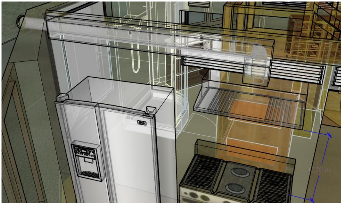
Ilustración 80: Vista rayos x de Ventilación forzada (Campana de cocina con expulsión hacia exterior)
