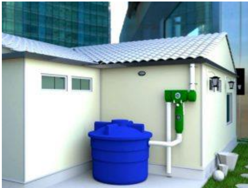
Ilustración 63: Sistema recuperación aguas lluvias (Captación filtrante)
