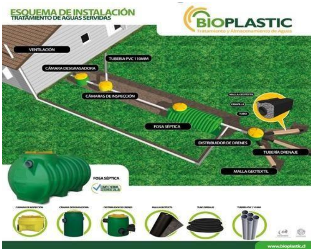
Ilustración 66: Tratamiento aguas negras Fosa Séptica (BIOPLASTIC)
