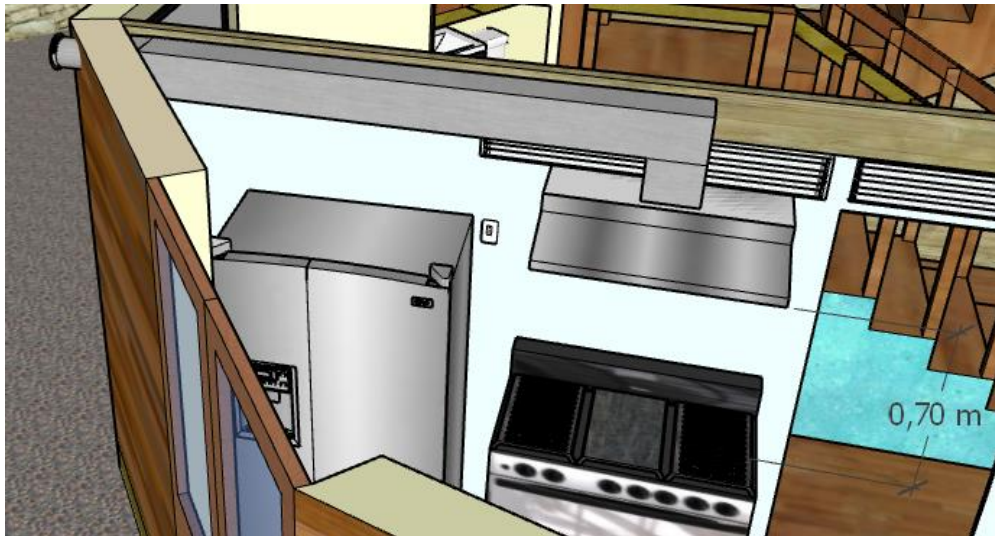
Ilustración 81: Instalación completa de sistema de extracción
