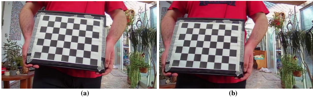
Figura 4.3: A partir de las imágenes de la figura 4.2: (a) imagen del tablero de ajedrez capturada por la cámara izquierda del sensor sin distorsión; (b) imagen del tablero de ajedrez capturada por la cámara derecha del sensor sin distorsión
