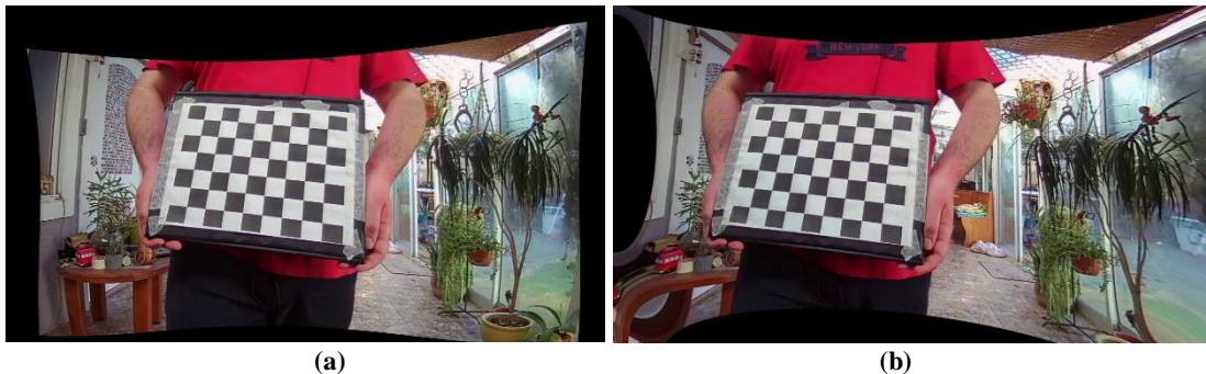
Figura 4.4: A partir de las imágenes de la figura 4.2: (a) imagen del tablero de ajedrez capturada por la cámara izquierda del sensor rectificada; (b) imagen del tablero de ajedrez capturada por la cámara derecha del sensor rectificada
