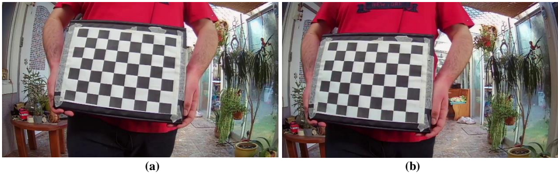
Figura 4.2: (a) Imagen del tablero de ajedrez capturada por la cámara izquierda del sensor; (b) imagen del tablero de ajedrez capturada por la cámara derecha del sensor
