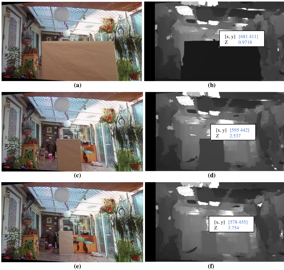
Figura 4.14: (a) Imagen entregada por el sensor con la caja ubicada a 1 m del sensor; (b) mapa de profundidad de (a) usando SGBM; (c) imagen entregada por el sensor con la caja ubicada a 3 m del sensor; (d) mapa de profundidad de (c) usando SGBM; (e) imagen entregada por el sensor con la caja ubicada a 5 m del sensor; (f) mapa de profundidad de (e) usando SGBM
