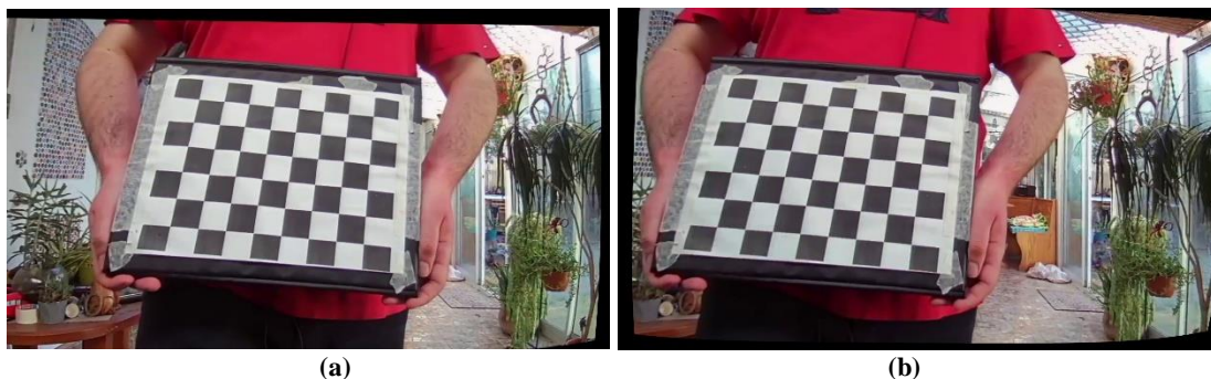
Figura 4.5: A partir de las imágenes de la figura 4.2: (a) imagen del tablero de ajedrez capturada por la cámara izquierda del sensor rectificadas con el proceso modificado; (b) imagen del tablero de ajedrez capturada por la cámara derecha del sensor rectificadas con el proceso modificado
