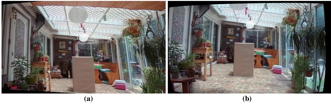
Figura 5.13: Con una separación de 30 cm entre los sensores y con los sensores en paralelo: (a) imagen entregada por el sensor izquierdo; (b) imagen entregada por el sensor derecho
