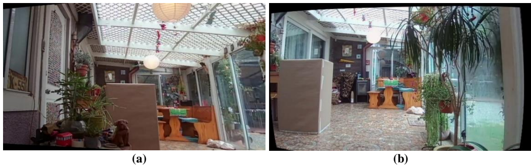
Figura 5.14: Con una separación de 150 cm entre los sensores y con los sensores en paralelo: (a) imagen entregada por el sensor izquierdo; (b) imagen entregada por el sensor derecho
