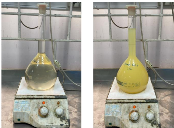
Figura 3.4: Preparación y pre-neutralización del extractante Cyanex 936P
