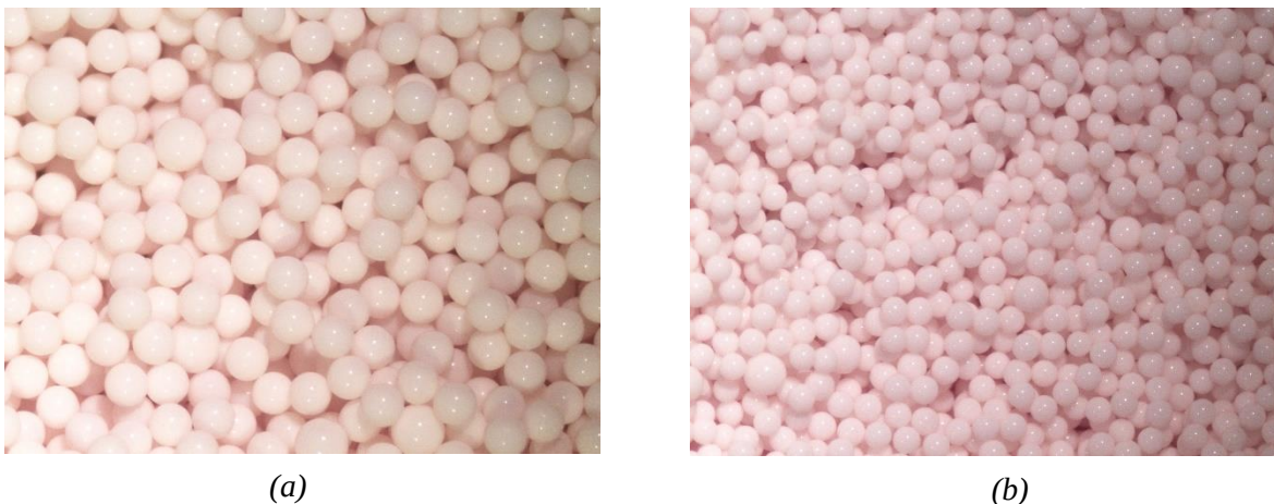
Figura 3.9: Imágenes de las resinas utilizadas tomadas al mismo aumento 8x. (a) Resina Monoplus TP208. (b) Resina MDS TP208
