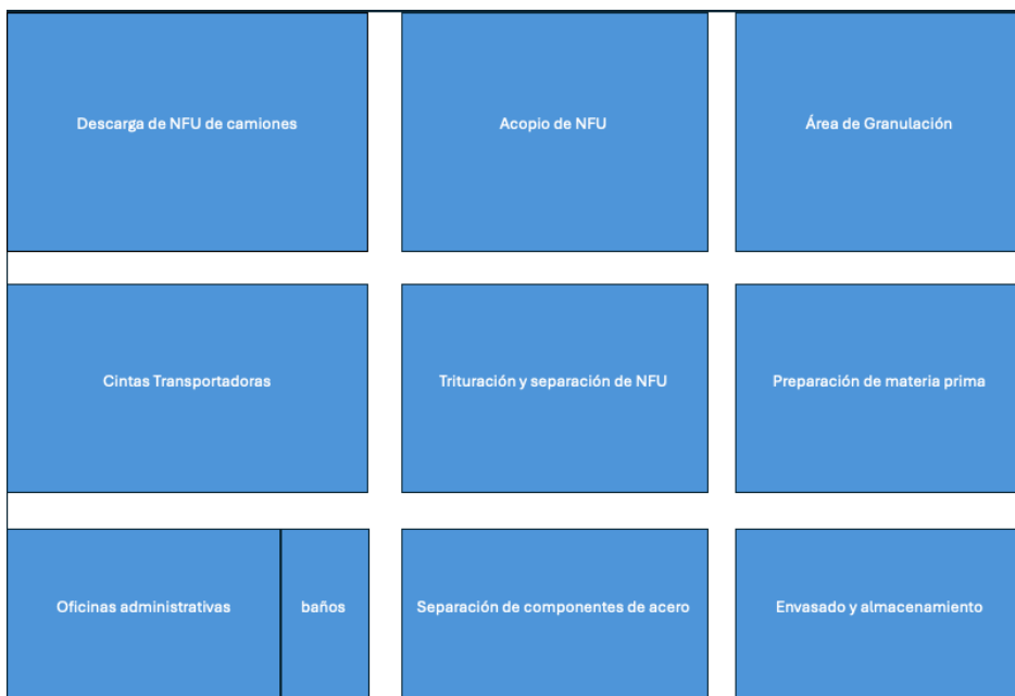
Plano 1-1. Propuesta de vista de planta, proyecto planta de reciclaje NFU
