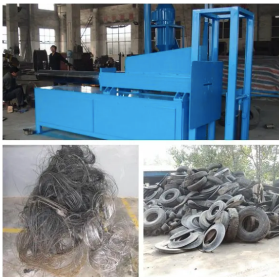
Figura 1-5. Maquina extractora de alambre de acero para neumático.
