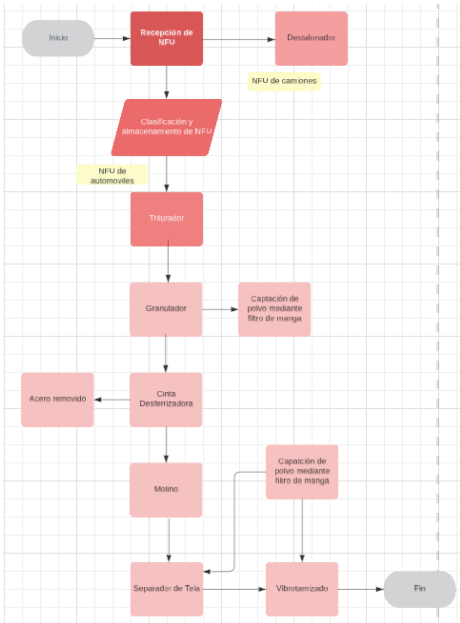
Figura 1-13. Diagrama de flujo de procesos, de las etapas del reciclaje de NFU.
