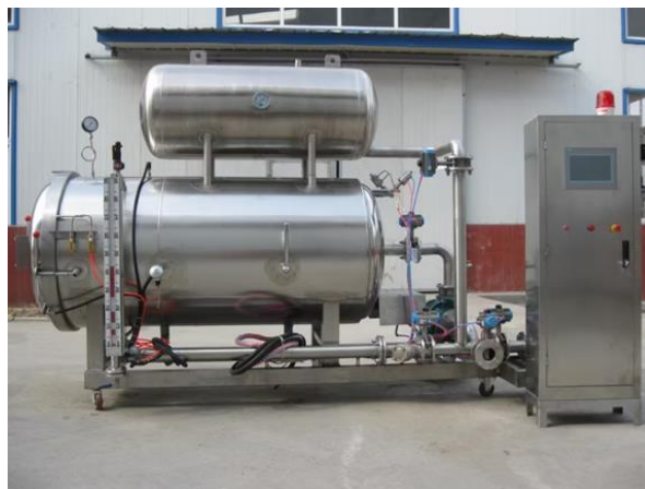
Figura 5 equipo industrial de hidrólisis alcalinas tipo autoclave, utilizado para el tratamiento seguro de residuos orgánicos animales, el cual permite controlar las condiciones de temperatura, presión y alcalinidad necesarias para asegurar la esterilización del material y la eficiencia del proceso
