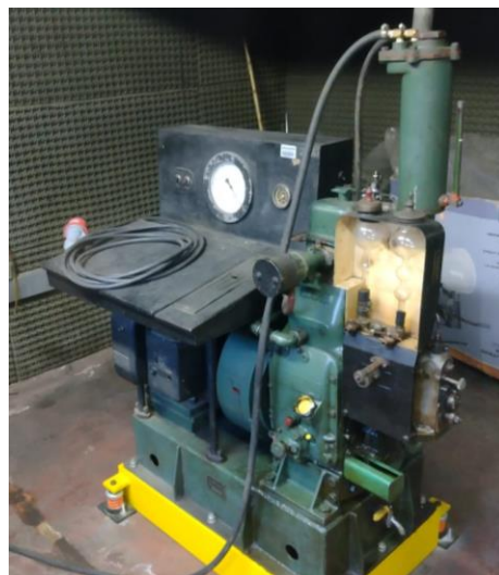
Figura 9. Motor MWM KD12E utilizado como cetanómetro en la Universidad Técnica Federico Santa María Campus Casa Central, Valparaíso.
