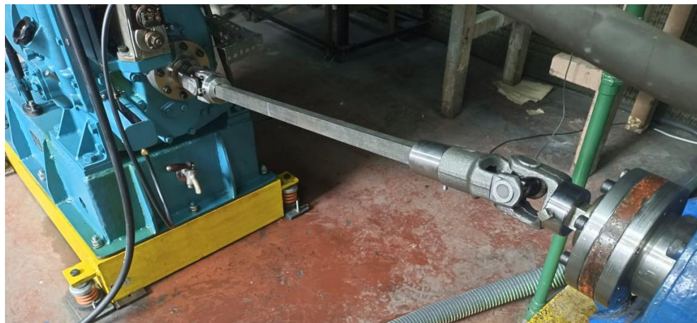
Figura 80. Unión cardánica entre el motor MWM KD12E y el freno dinamométrico.
