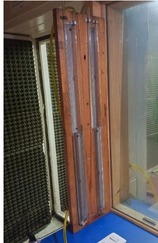
Figura 81. Tablero con 2 columnas graduadas en [mm] para obtener presión en agua y mercurio según se requiera.
