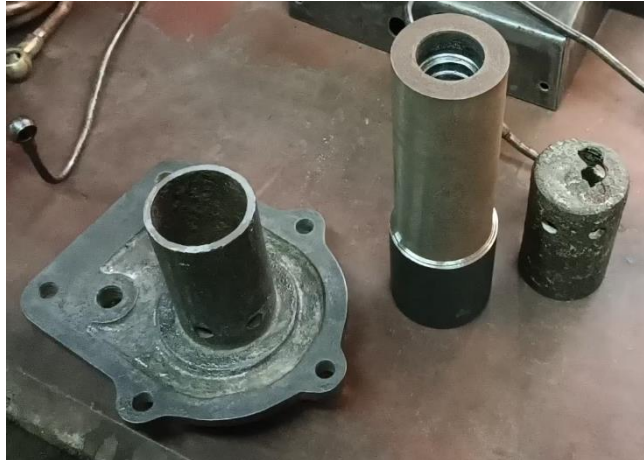
Figura 16. Intercambiador intervenido y en el centro la barra de acero SAE 4340.
