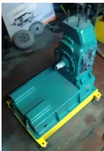
Anexo 5. Chasis y bloque del motor MWM restaurados y pintados.
