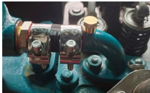
Figura 68. Solución para la instalación de la termocupla en la salida de agua de la culata del equipo.
