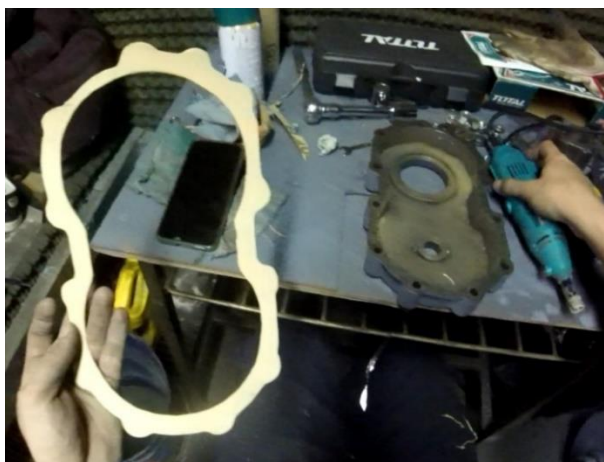
Anexo 4. Fabricación de la empaquetadura de la tapa de distribución de la bomba de aceite.
