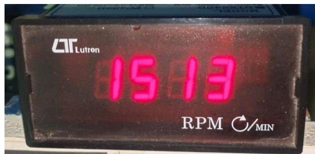
Figura 71. Display digital que muestra las revoluciones del motor MWM.
