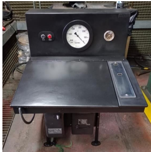
Figura 21. Tablero de instrumentos, caja de conectores trifásicos y caja de convertidor restaurados.
