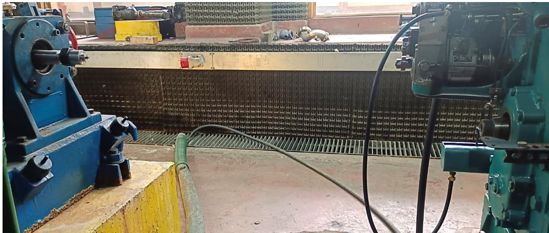
Figura 73. Separación entre el eje del freno dinamométrico y el eje principal del motor MWM KD12E.
