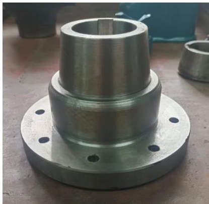
(a) Dämper reparado
