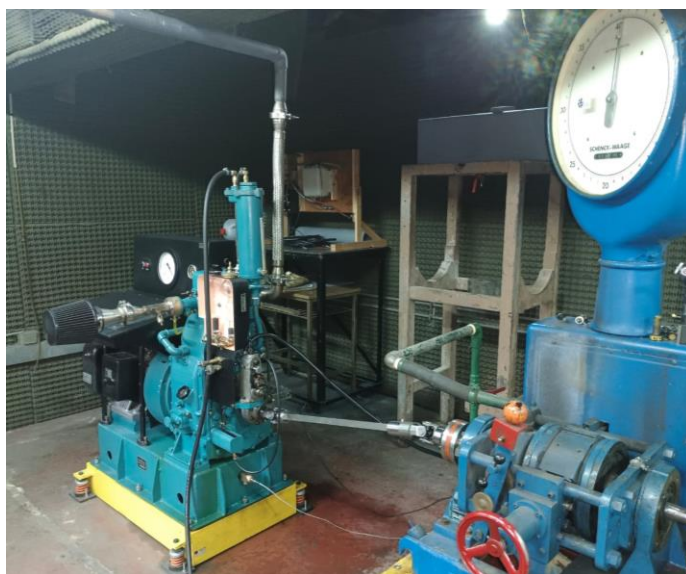
Figura 83. Motor MWM KD12E adecuado para pruebas con inyección indirecta de hidrógeno.
