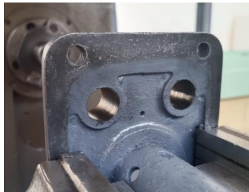
Figura 18. Perforaciones de 18.5 [mm] para crear las roscas M20x1.5 de relleno.
