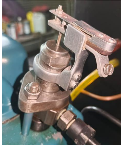
Figura 25. Sensor de inyección de combustible en la parte superior del inyector.
