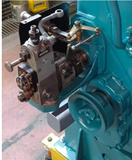
Figura 43. Cubiertas laterales instaladas, a la izquierda la tapa soporte con la bomba de inyección y a la derecha la tapa de distribución de la bomba de aceite con su respectivo dámper.
