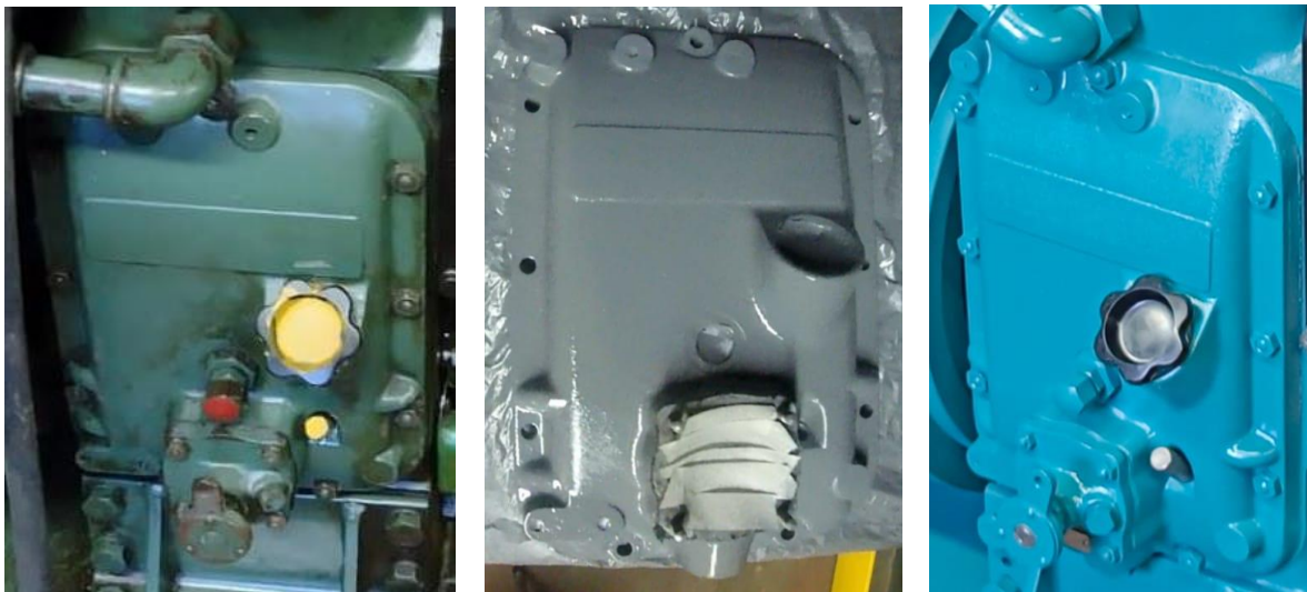
Figura 39. Conjunto tapa frontal del motor MWM KD12E en su proceso de restauración.
