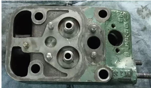
Figura 35. Culata de motor MWM KD12E.
