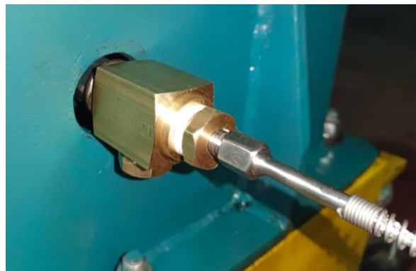
Figura 69. Termocupla instalada en el cárter del motor MWM KD12E.
