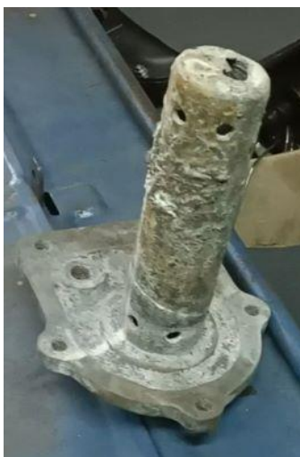
Anexo 2. Intercambiador de calor post baño químico con ácido.
