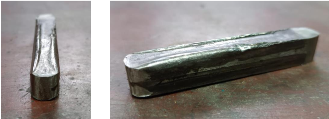
Figura 79. Chaveta original de la unión en el freno dampér -eje desgastada por el sobredimensionamiento de esta.
