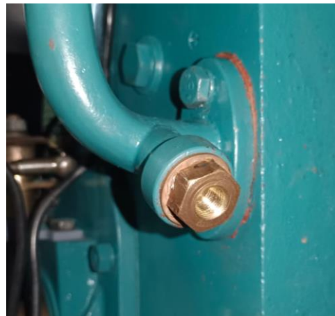
Figura 66. Tapón de refrigerante roscado para la instalación de la termocupla de entrada al bloque motor.
