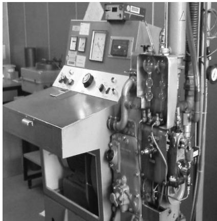
Figura 2. Instalación estacionaria equipada con un motor MWM KD12E para medir la inflamabilidad de combustible Diesel. (Dansk Standard, 2017)
