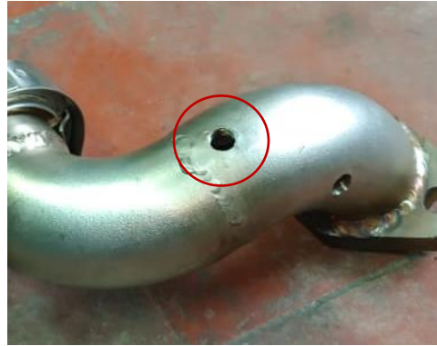
Figura 65. En rojo se encuentra la posición de la termocupla de salida de los gases de escape. La rosca a la derecha se utiliza para el condensador de la línea de evacuación de gases.
