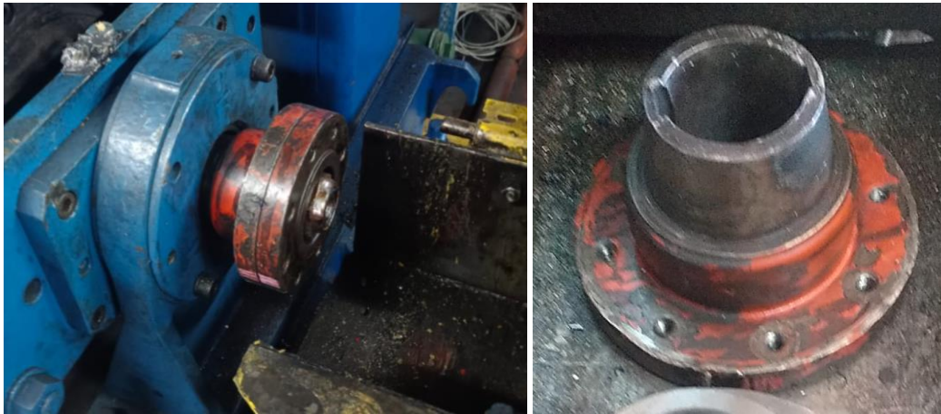
Figura 75. Dámper del freno dinamométrico en su posición original, orientado a la conexión con el motor Perkins. En la imagen derecha se puede apreciar el cono exterior del dámpfer en el sector sin pintura.
