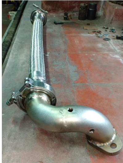
Figura 61. Múltiple de escape soldado y acoplado con el flexible de la línea de evacuación de gases de combustión.
