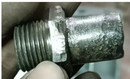
Anexo 1. Conexión antigua hacia el sifón desde el retorno de la culata.
