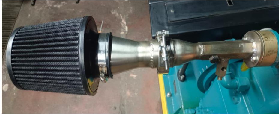
Figura 58. Múltiple de admisión nuevo instalado en el regulador de aire del equipo.
