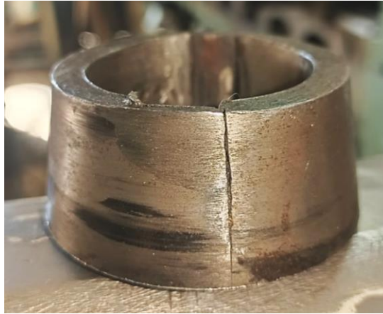
Figura 76. Fractura longitudinal a la sección cónica del dämper del freno dinamométrico.
