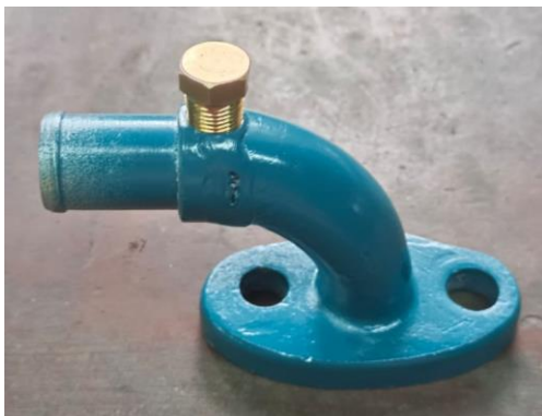
Figura 68. Solución para la instalación de la termocupla en la salida de agua de la culata del equipo.
