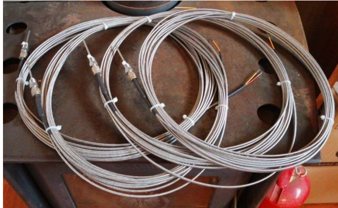
Figura 63. Termocuplas tipo K con rosca 1/8" NPT, bulbo de 30 [mm] de largo y cable de malla de 10[m] de extensión.
