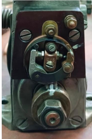
Figura 23. Sensor de inicio de la elevación de combustible tipo platino de la bomba inyectora.
