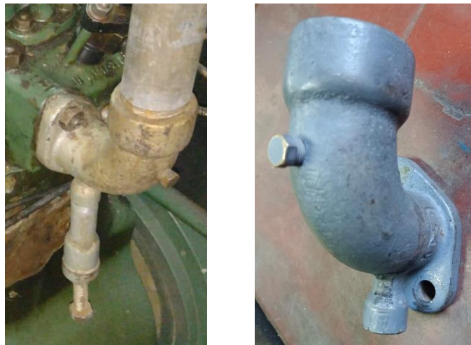
Figura 45. Múltiple de escape original del motor MWM KD12E antes y después de la restauración.
