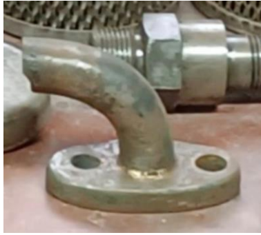
(a) Cañería de salida de refrigerante
