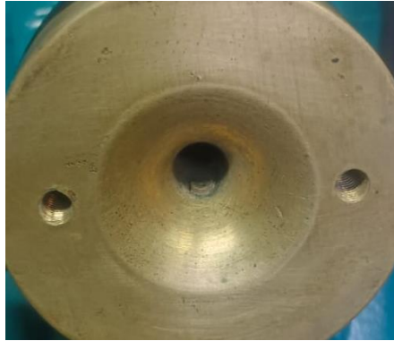
Figura 52. Receptor de bronce de la válvula reguladora de aire de admisión. Se puede distinguir en el centro de la imagen, el cono desde el exterior hacia la entrada de aire del motor.
