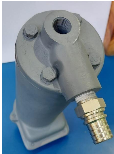
Figura 15. Estanque y componentes inferiores del sifón restaurados.
