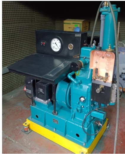
Figura 47. Motor MWM KD12E listo para operar después del overhauling.
