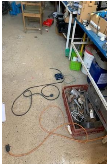
Figura N°11. Pasillos obstruidos y materiales en zonas de tránsito. Fuente: Elaboración propia
