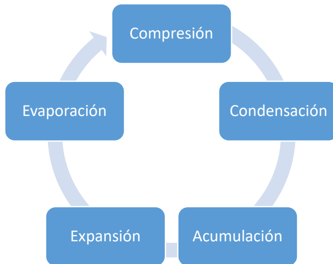
Figura 21: Procesos en el ciclo de Refrigeración (Fuente: Elaboración propia, 2021).
