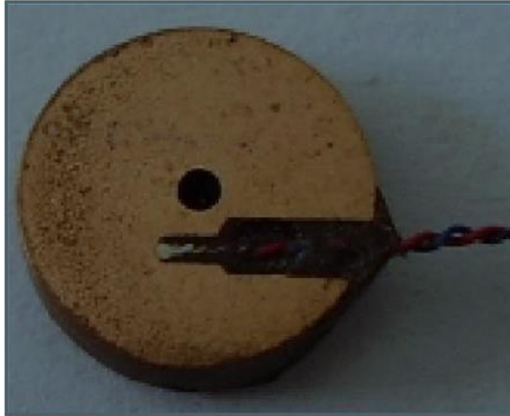
Figura 21. Imagen agrandada de la sección transversal donde se mide la temperatura de pared presente en (Matkovic et al., 2009)
