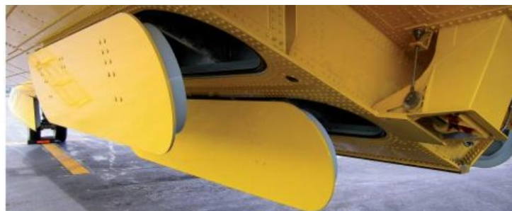
Ilustración 3.4.1: Compuertas del estanke ventral de la aeronave Bombardier 415.
