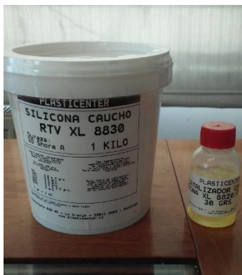
Figura 12.6; Caucho de silicona RTV XL 8830 1[Kg] junto con su catalizador.
