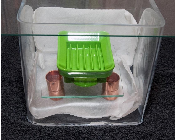
Figura 1.16: Montaje de proceso de pulido por vapor de acetona en frío, con paredes rodeadas de papel absorbente, empapado con acetona. [23]
