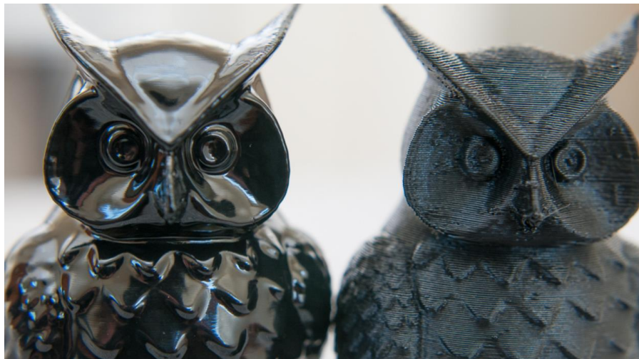
Figura 1.20: Comparación post y pre pulido mediante vapor de acetona. [21]
