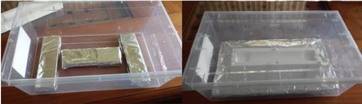
Figura 3.25: Al lado izquierdo se presenta el montaje de boques al interior del contenedor para el pulido por vapor de acetona. Al lado derecho se encuentra el montaje completo.
