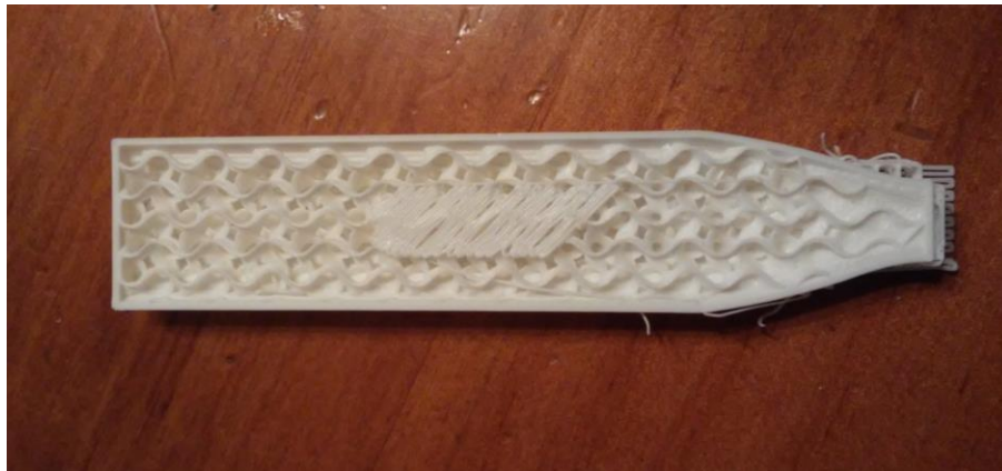
Figura 3.16: Relleno de una impresión fallida de uno de los núcleos.
