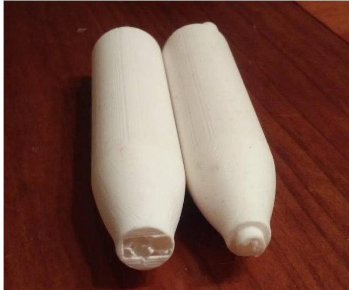
Figura 5.2: Núcleo D10-H y D10-M posterior a la fractura del vástago.
