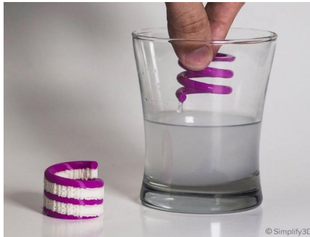
Figura 1.13: Disolución en agua de soportes de impresión del material PVA. [18]
