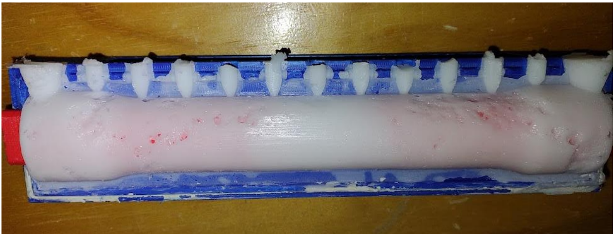
Figura 5.6: Resultado de prueba 2. Mostrando los surcos generados en la superficie del fantoma.
