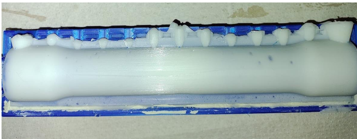
Figura 5.4: Resultado de prueba 1, con burbujas concentradas en la parte superior del fantoma.
