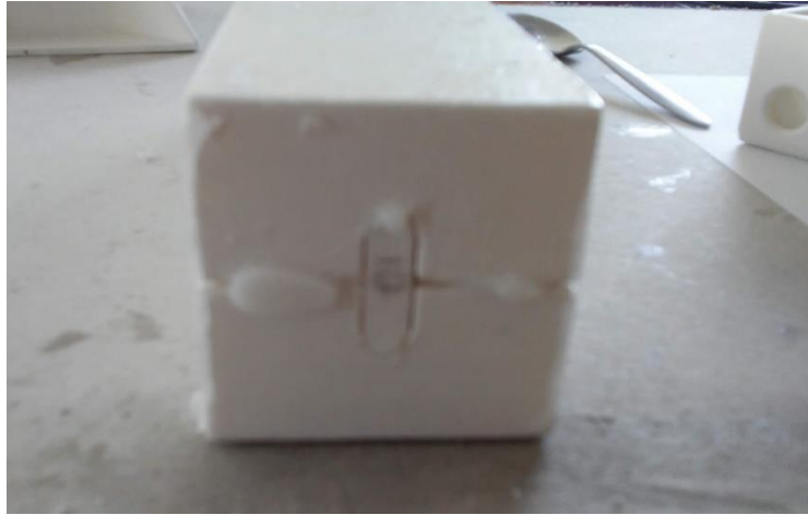
Figura 5.1: Vista inferior del molde posterior al proceso de curad, con filtraciones de silicona.
