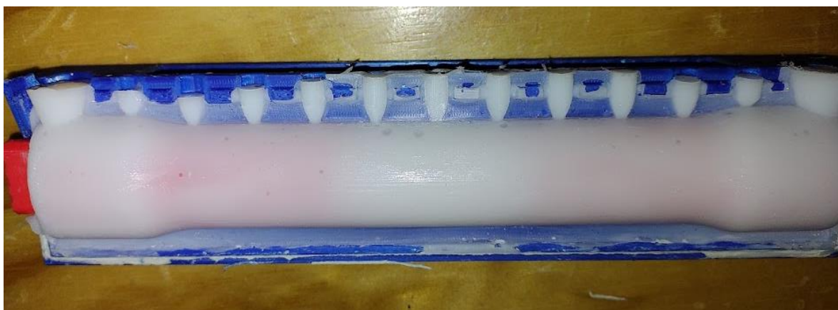
Figura 5.7: Resultado de prueba 3, con pequeñas burbujas en la parte superior del fantoma.
