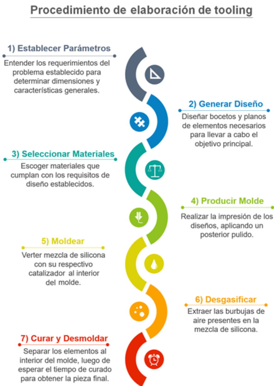
Figura 2.1: Esquema del proceso de fabricación de tooling.
