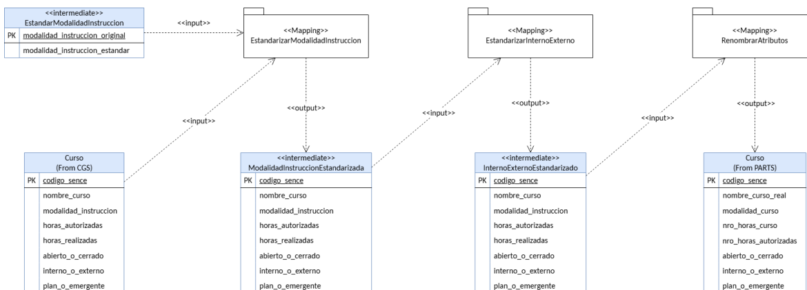
Figura 17: Diagrama de mapeo de datos de nivel de tabla de la clase Curso del esquema ParticipantesSchema Fuente: Elaboración propia
