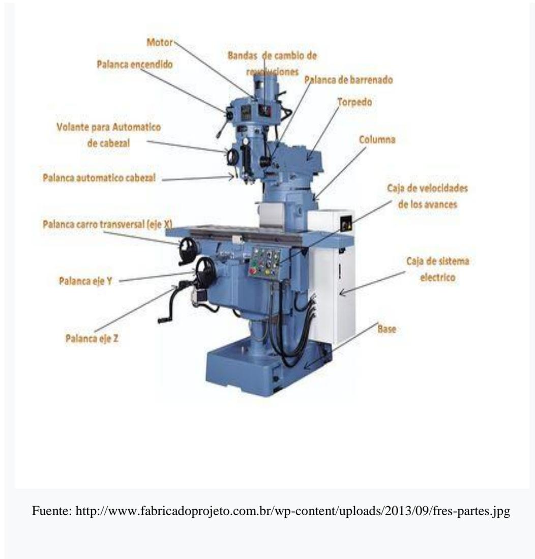
Figura 3-18. Partes de la fresadora vertical
