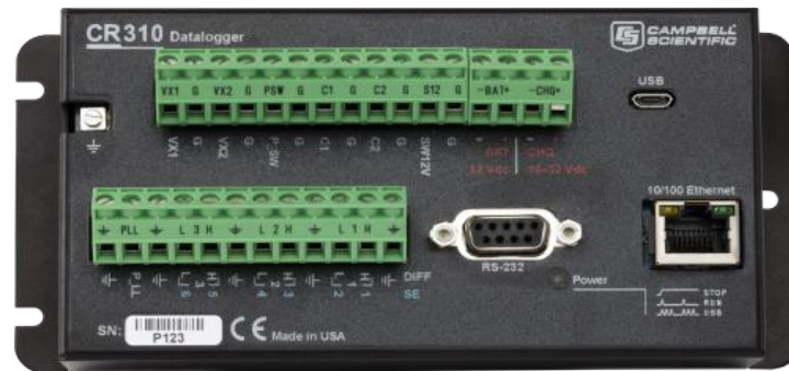
Figura 4-3: Entradas y conexiones de CR-310 de Campbell Scientific, utilizado para monitoreo y registro de datos.
