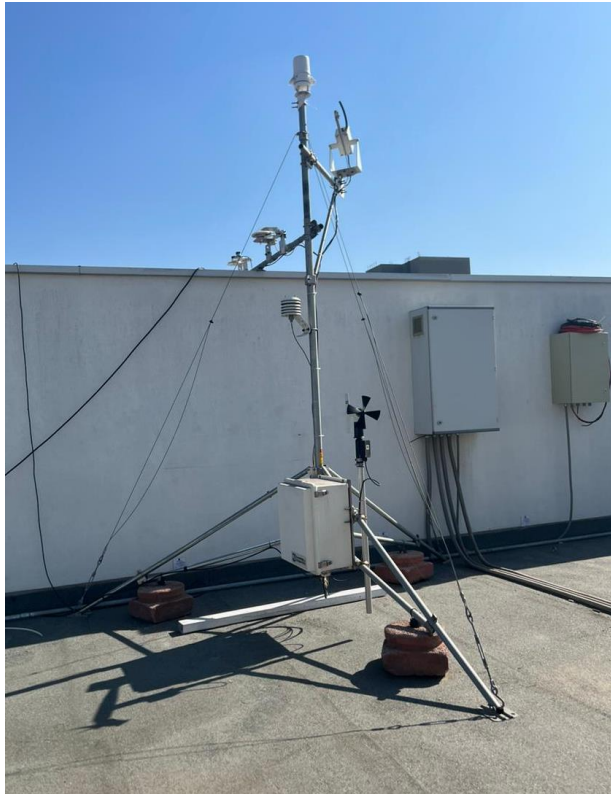
Figura 4-2: Estación meteorológica ubicada en el techo de la Universidad Técnica Federico Santa María.
