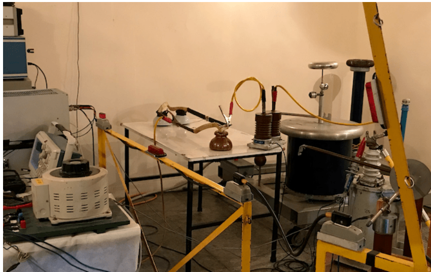
FIGURA 3.11: Montaje experimental para medición de DP en cabina blindada del Lab. de Alta Tensión.
