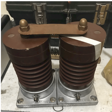
(a) Detalle del condensador de acoplamiento PDTech
