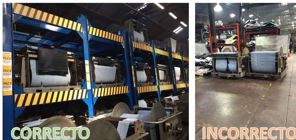
Figura 4.19: Comparativa de situación correcta/incorrecta en almacenamiento de cassettes. [Fuente: Goodyear Chile]
