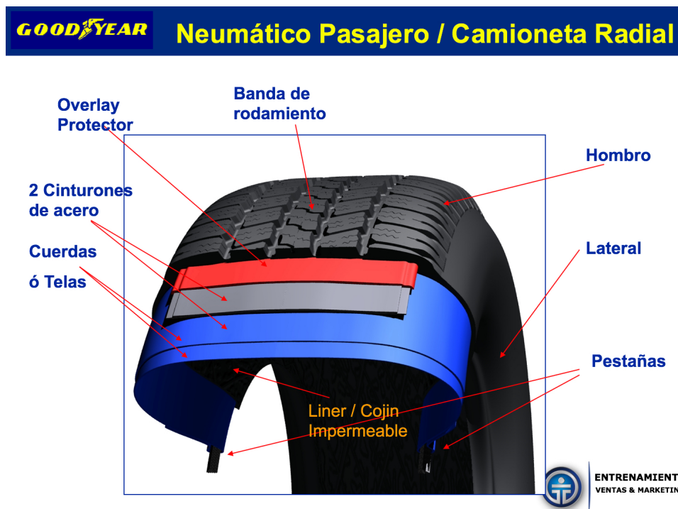
Figura 4.12: Componentes de un neumático. [Fuente: Goodyear Chile]
