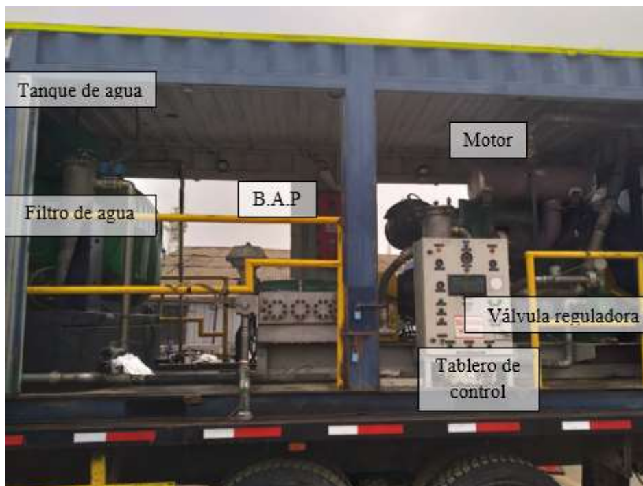
Figura 1-7: Sistema de limpieza alta presión, bomba Kamat
