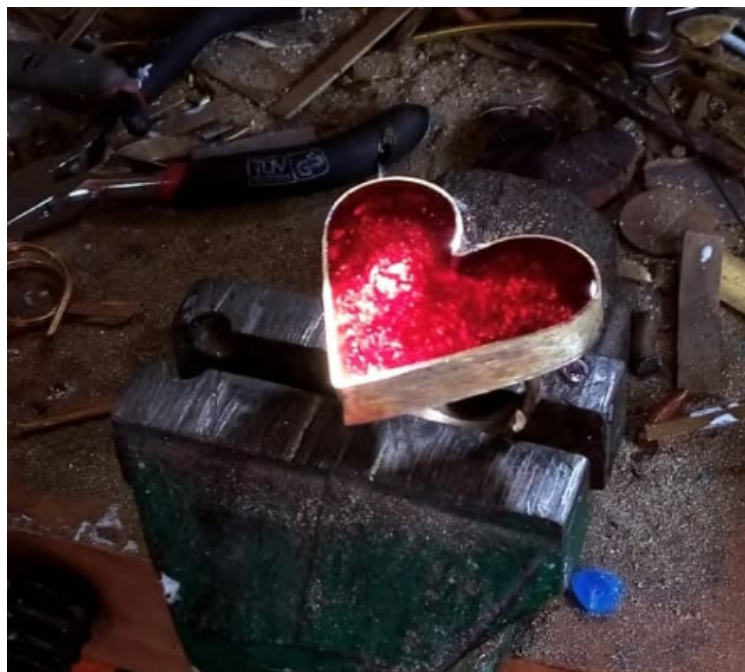
"Ilustración 4. Pieza en proceso de pulido sobre molde. Fuente: Tere Rubio Orfebres (2025), Instagram."
