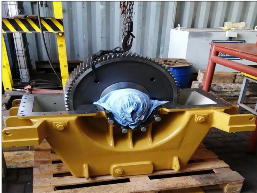
Figura 2-9. Maniobra de extracción del rodamiento de Eje de salida, Ciudad de Iquique.
