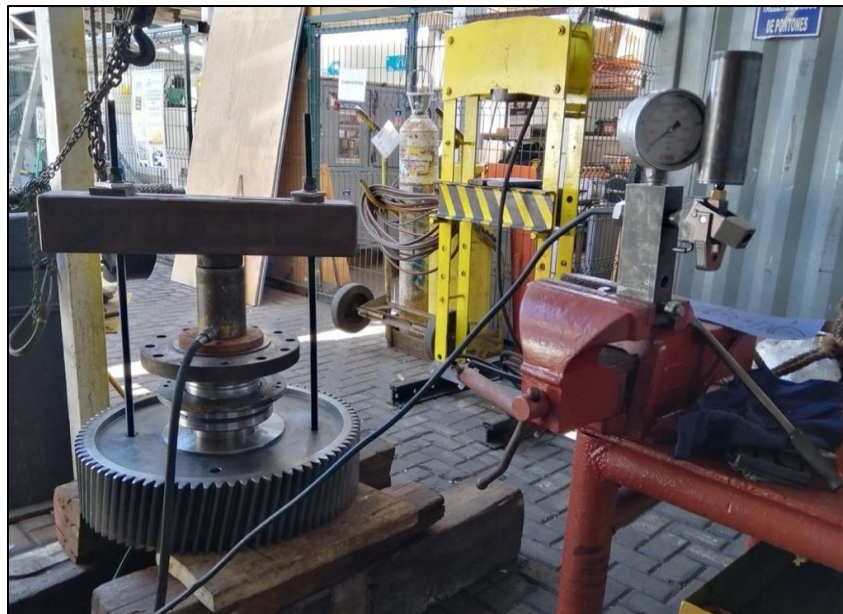
Figura 2-10. Extracción de piezas mecánicas por medio de presión hidráulica, ciudad de Iquique
