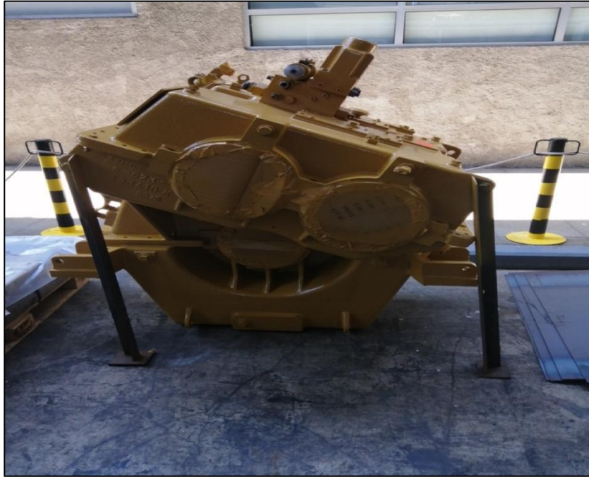
Figura 2-13. Caja reductora, lista para su instalación al interior de la embarcación pesquera.
