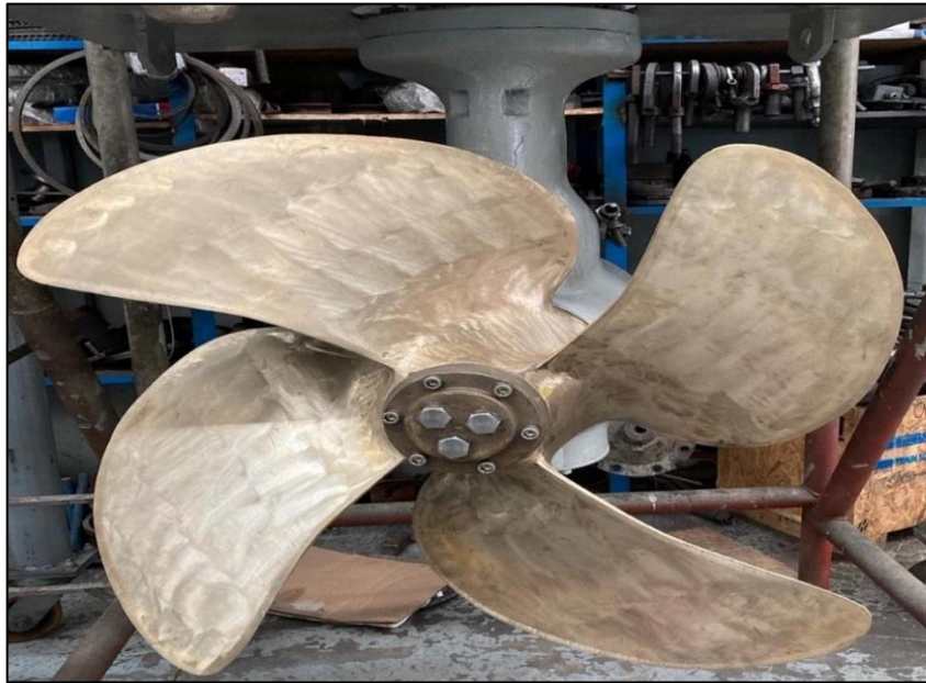
Figura 1-4. Hélice de cuatro aspas, usadas en barcos pesqueros industriales, con brida de acoplamiento.
