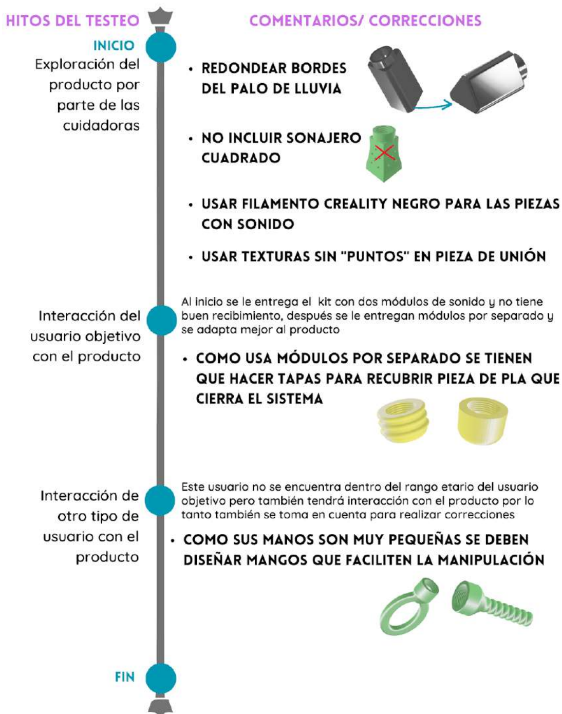
Figura 120, diagrama de relación entre testeo y correcciones, elaboración propia.
