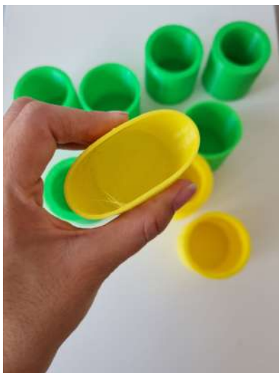
Figura 50, 51 y 52, Prueba de resistencia de fuerza en cilindros con pared de 3 [mm],
