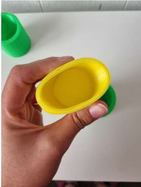
Figura 47, 48 y 49, Prueba de resistencia de fuerza en cilindros con pared de 5[mm], respectivamente con 20%, 50% y 100% de relleno.
