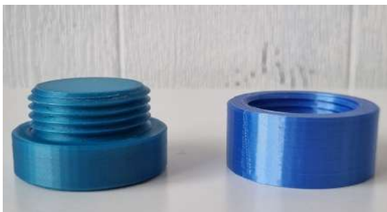
Figura 72, Imagen de prototipos método de unión en PLA, elaboración propia.
