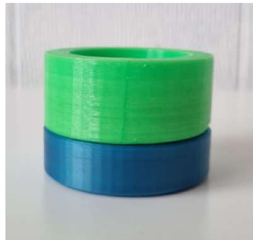
Figura 73, Imagen de prototipos método de unión, combinación definitiva (TPU y PLA), elaboración propia.
