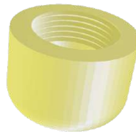
Figura 123 y 124, Modelos 3D tapas para cubrir PLA cuando se usan módulos separados, elaboración propia.
