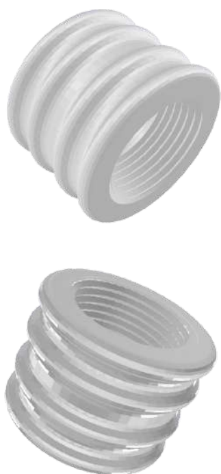
Figura 125 y 126, Modelo 3D pieza de unión entre 2 módulos de sonido, elaboración propia.
