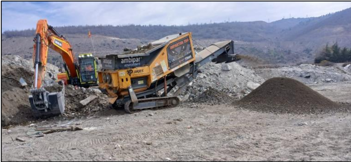
Figura 11. Trituración del material.
