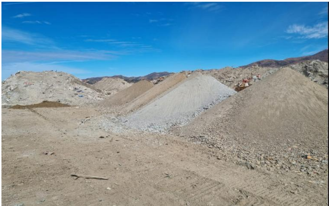
Figura 12. Producto de trituración separados por granulometría.
