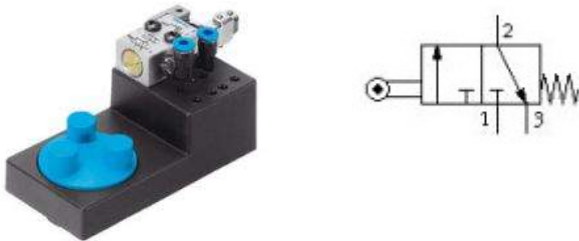
Ilustración 2-8: Válvula 3/2 de rodillo. Fuente: https://www.festo-didactic.com
