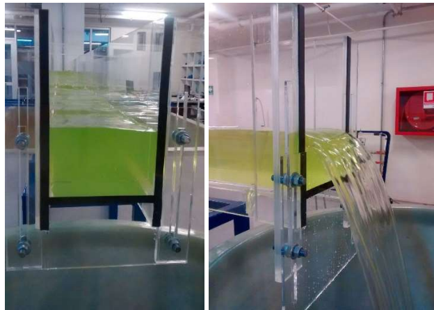
Figura 5.6. Vertedero frontal del canal instalado y funcionando.
