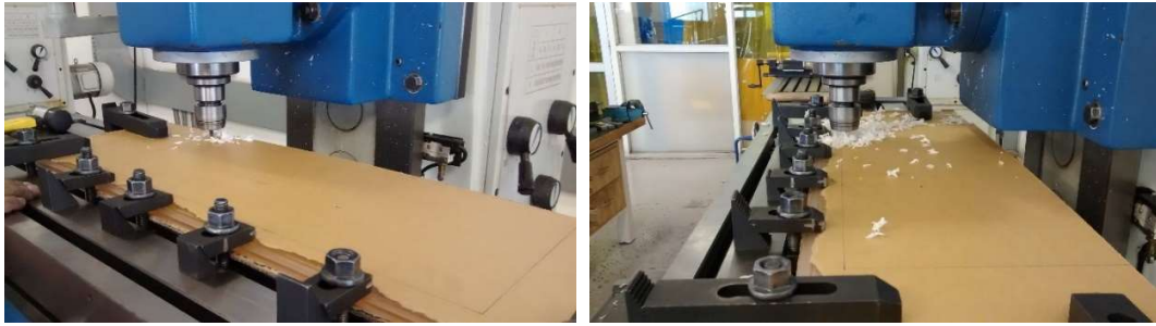
Figura 5.7. Mecanizado de las piezas para el vertedero lateral.
