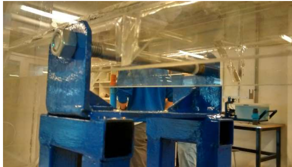
Figura 5.16. Apoyo tipo pasador del canal con pernos de 5/8”.
