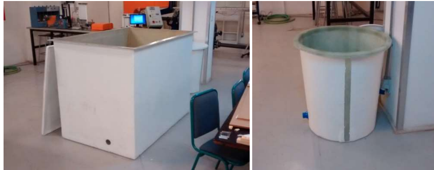
Figura 5.14. Estanques volumétrico y de almacenamiento del canal.
