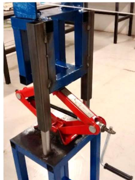
Figura 5.12. Gata de tijeras soldada y asegurada a la estructura A.
