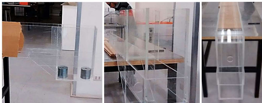
Figura 5.5. Estanque regulador unido al canal principal.
