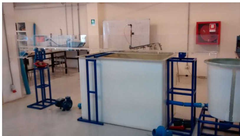
Figura 5.15. Canal ubicado sobre apoyos metálicos y estanque ubicados.
