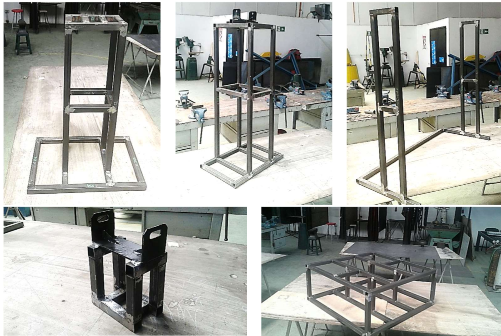
Figura 5.11. Estructuras metálicas soldadas.
