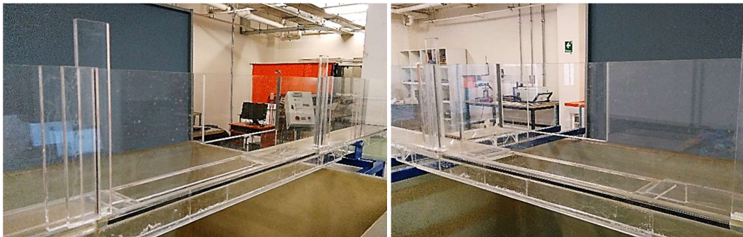
Figura 5.8. Pieza de vertedero lateral terminada e instalada en el canal.
